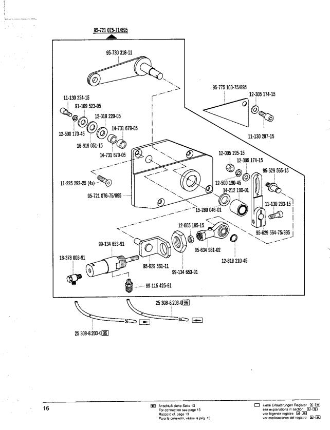
Grundplattenteile Bedplate parts Pièces du plateau fondamental Piezas de la placa-base PFAFF 3568-12/22
