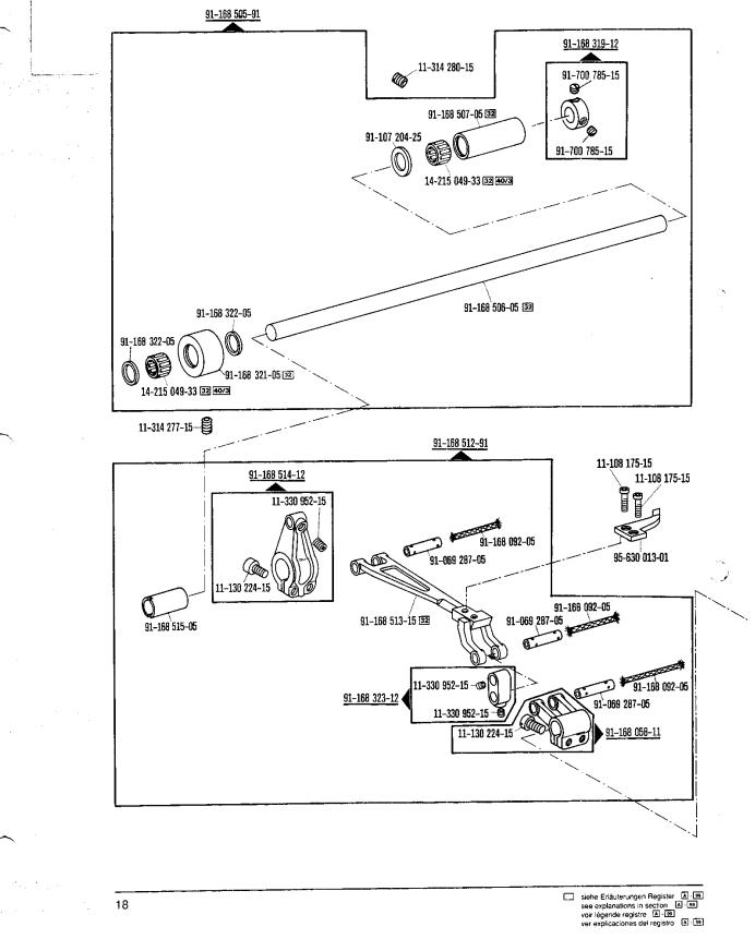
Grundplattenteile Bedplate parts Pièces du plateau fondamental Piezas de la placa-base PFAFF 3568-12/22
