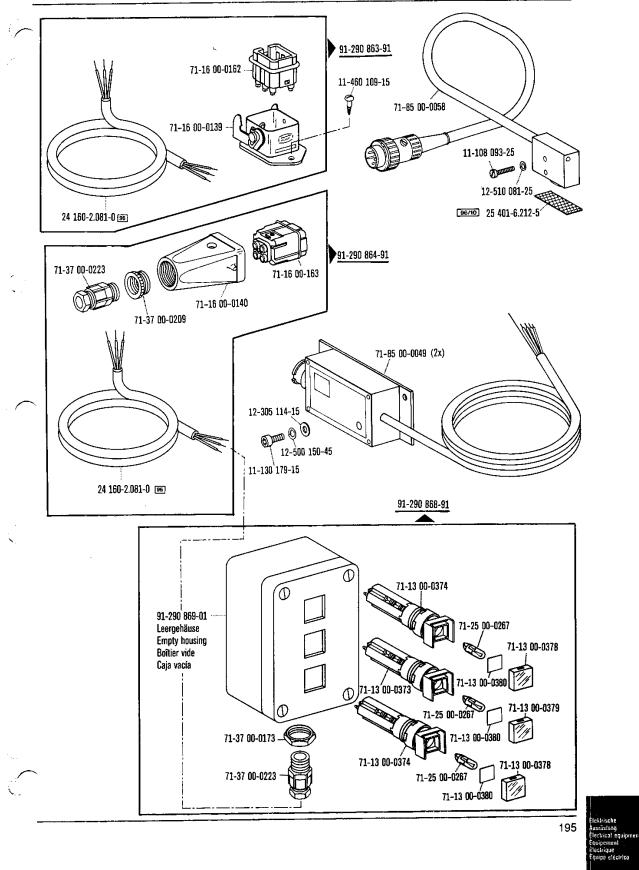
Elektrische Ausrüstung Electrical equipment Equipement électrique Equipo eléctrico PFAFF 3568-12/22
