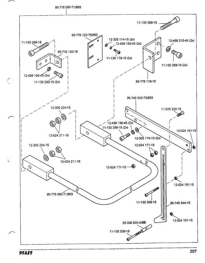
Verkleidung mit Schutzbügel Housing and guard Cache et étrier de protection Revestimiento y estribo de protección
