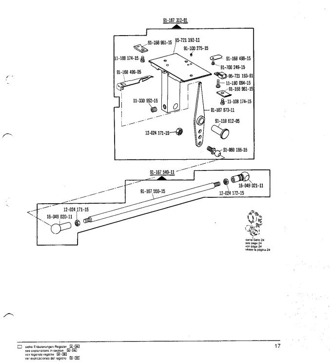
Grundplattenteile Bedplate parts Pièces du plateau fondamental Piezas de la placa-base PFAFF 3568-12/22
